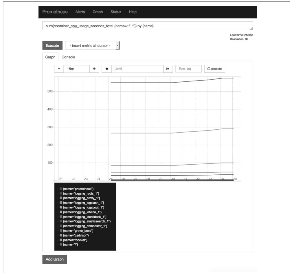
图 10-6：用 Prometheus 绘制的容器 CPU 使用率图表
