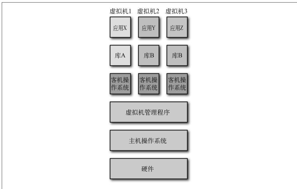
图 1-1：运行在同一台主机上的 3 个虚拟机
