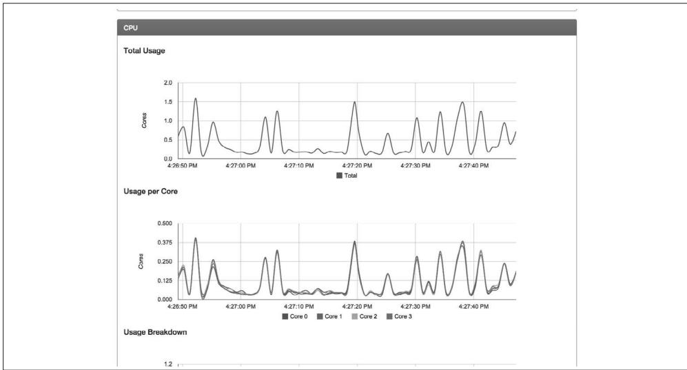
图 10-5: cAdvisor 中关于 CPU 使用率的图表
