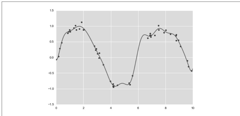
图 5-46：通过自定义转换器，实现高斯基函数拟合
