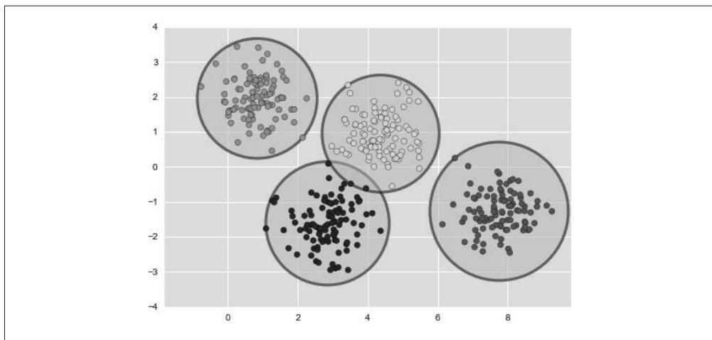
图 5-125:  $k$ -means 模型隐含的圆形的簇
