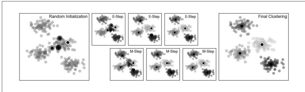
图 5-112:  $k$ -means 的 E-M 算法的可视化
